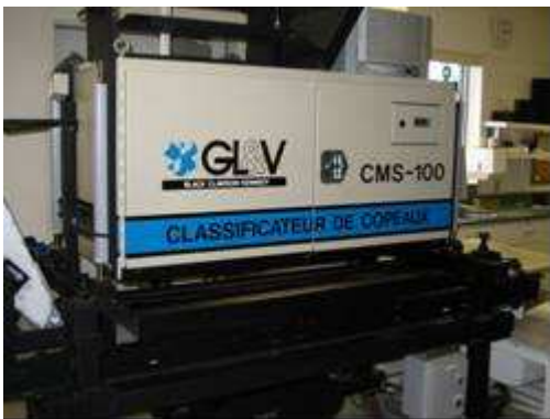
”Vithetsgraden” mäts för styrning till rätt flisstack med en GL&V Black Clawson Kennedy classifier CMS 100. Testet tar 90 sekunder.
