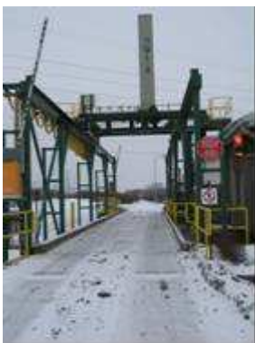
Den automatiska flisprovtagaren GLV som fanns vid fabriken uppgavs av mätarna vara dyr och ha tekniska problem. Den var trasig vid studiebesöket. Bilden till höger visar den borrh som samlar in provet.
